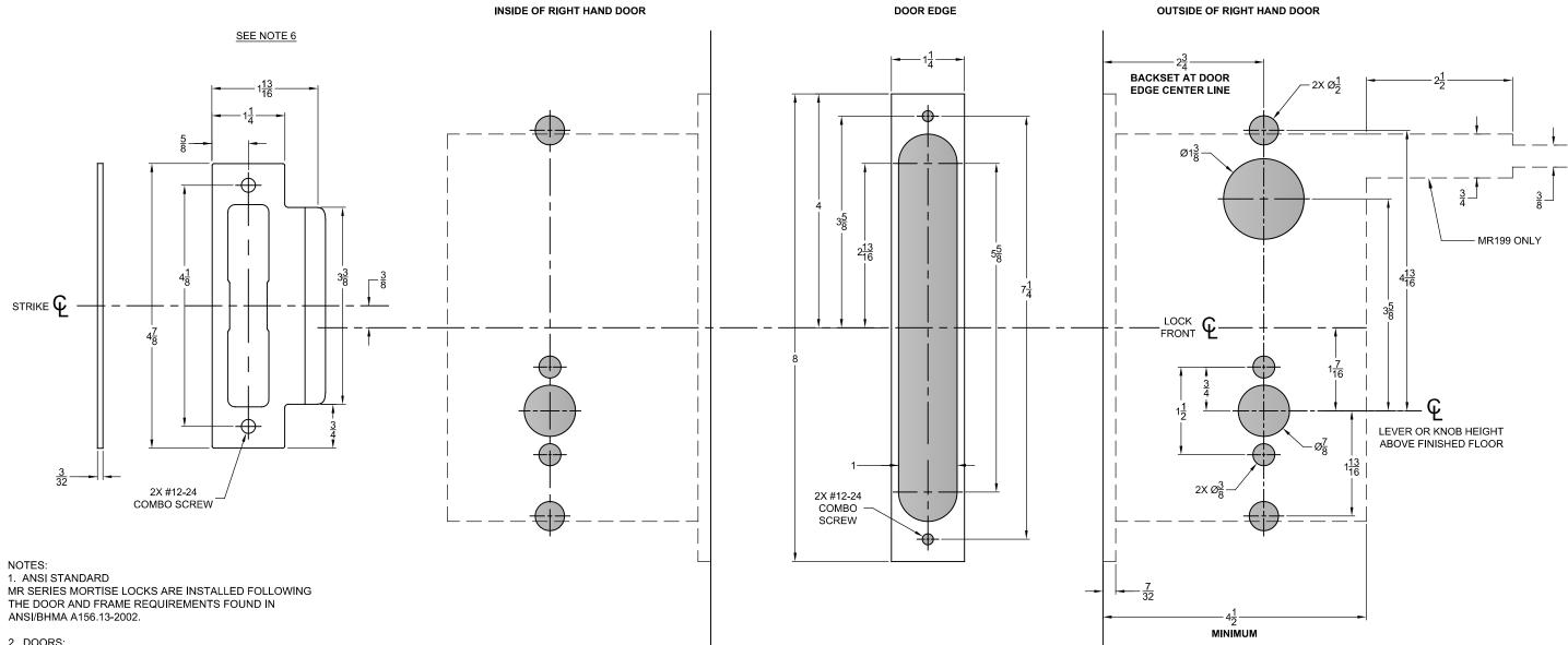
REINFORCEMENT IS REQUIRED PER ANSI A115.1-1991.
