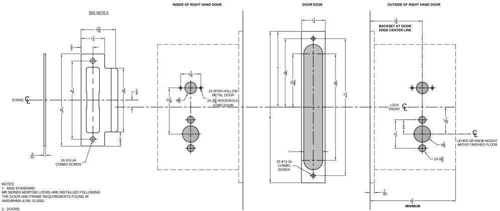
REINFORCEMENT IS REQUIRED PER ANSI A115.1-1991.
