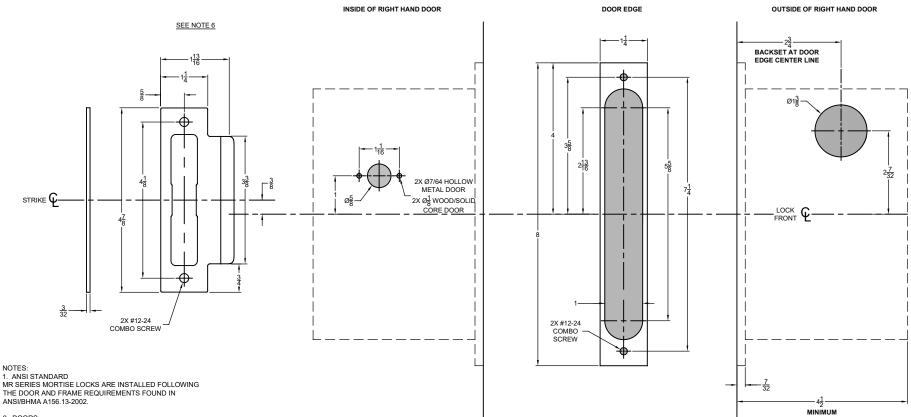
2. DOORS: REINFORCEMENT IS REQUIRED PER ANSI A115.1-1991.
